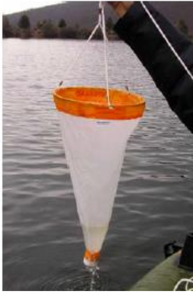
Imagen 2: Toma de muestras cualitativa de zooplancton mediante red de plancton.
